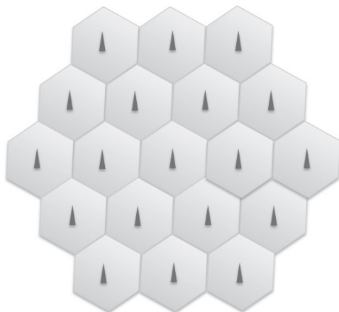
Figura 2 Topología para evaluación de red MBMS
