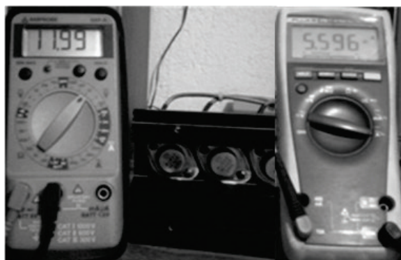
Figura 23 Medición de voltaje y corriente a plena carga, 2.2\Omega
