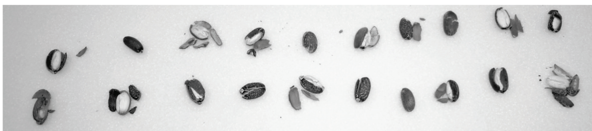
Figura 6 Granos de Jatropha curcas después de ser sometidos al ensayo de fuerza de fractura
