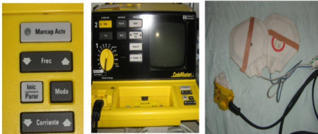
Figura 1. Marcapasos transcutáneo. En (A) se observan los botones de encendido, frecuencia, y corriente, que deben ajustarse para hacerlo funcionar. En (B) se observa el tablero de un monitor actual, que puede cumplir funciones de desfibrilador, monitor y marcapasos. Con flechas se indican los dispositivos de accionar para el funcionamiento del marcapasos. En (C) se muestran los electrodos que van sobre el tórax del paciente y los cables que se conectan al desfibrilador-monitor-marcapasos. (ver anexo)
