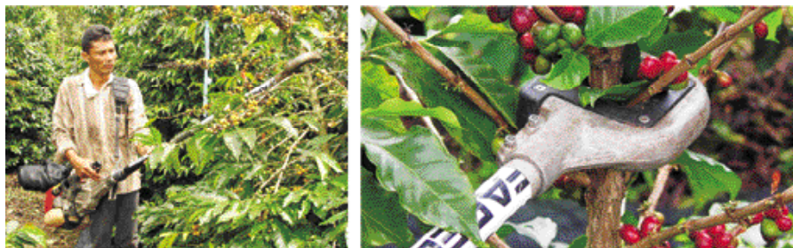
Figura 1. Vibrador portátil Cifarelli SC700®, vista general del equipo y acople de la lanza al tallo del cafeto
