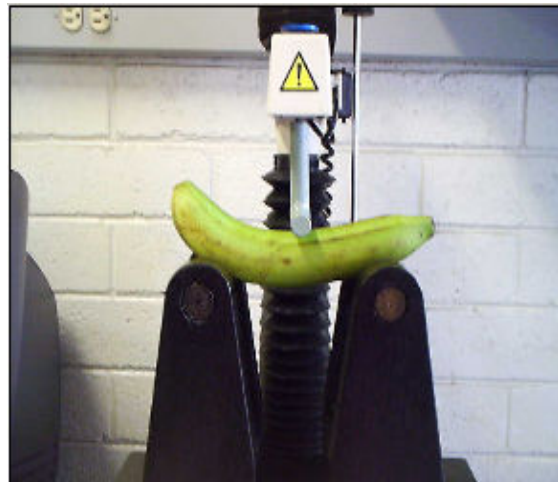
Figura 6. Prueba de fractura a compresión y flexión en banano var. Cavendish Valery.
