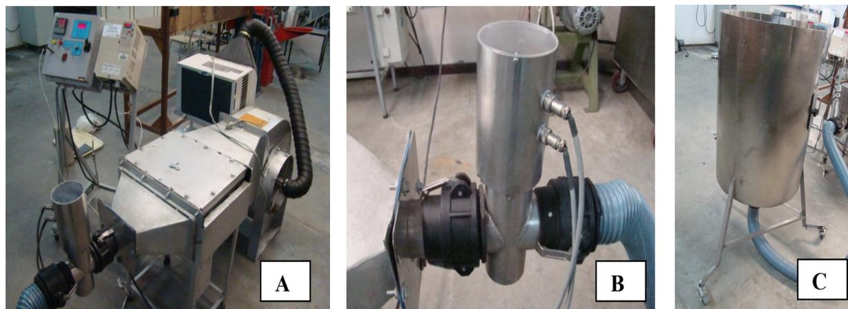
**Figura 1.** Secador de café lecho fijo con sistema de flujo de aire e intermitencia térmica: ventilador, intercambiador de calor y sistema de control (A); válvula rotativa para generación del pulso de aire (B); lecho fijo de café (C).
