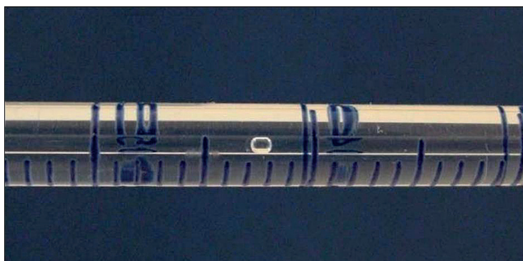
Figura 2. Medición de tasa de flujo de permeabilidad
