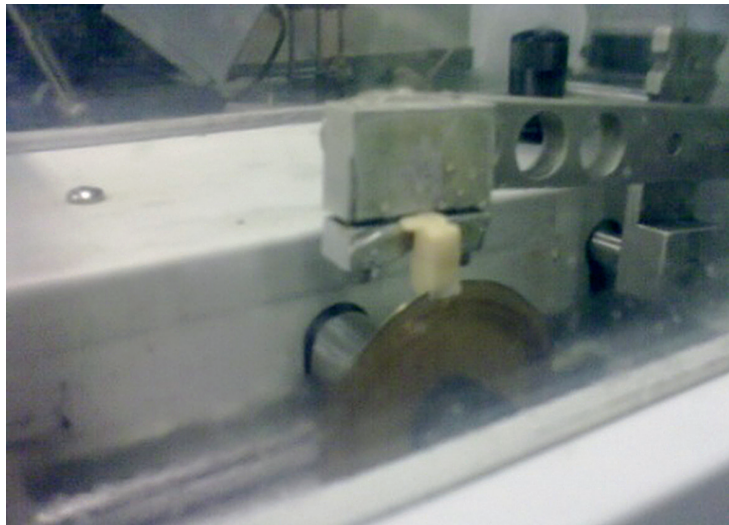
Figura 2. Seccionado de una de las muestras en la cortadora Buehler Isomet 1000 Precision, posterior a su proceso de cementación
