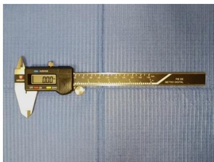
Figura 1. Calibrador vernier digital Ubermann 0-150 mm / 6" Fuente: por los autores
