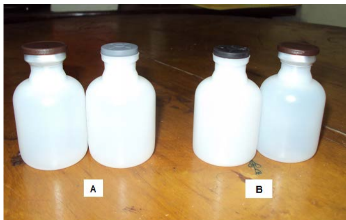
Figura 6. Imágenes del resultado de la prueba de hermeticidad del sistema envase-cierre con azul de metileno. (A)- Tapón RL8-9-105/0, izquierda: control positivo, derecha: muestra de frascos ensayados; (B)- Tapón FM84/5, izquierda: muestra de frascos ensayados, derecha: control positivo.
