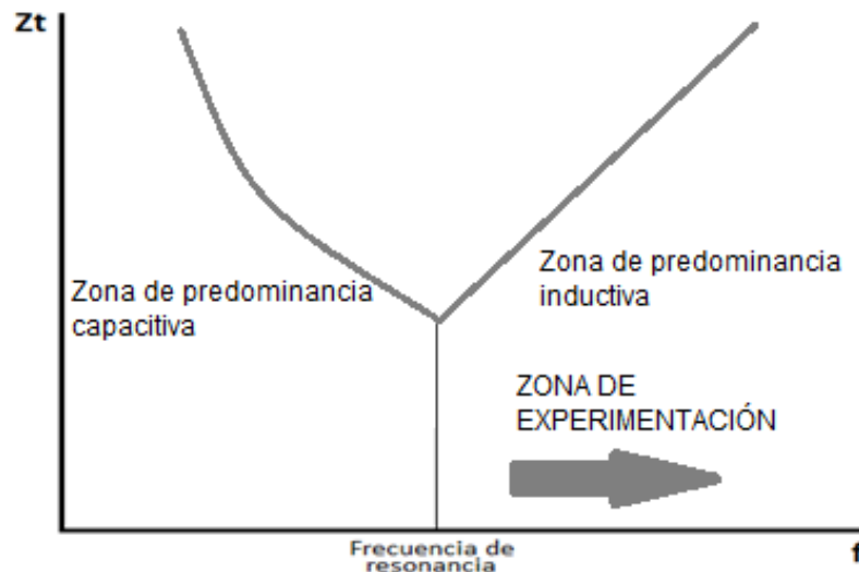
Figura 8. Impedancia del circuito en función de la frecuencia para el sistema DBD.
