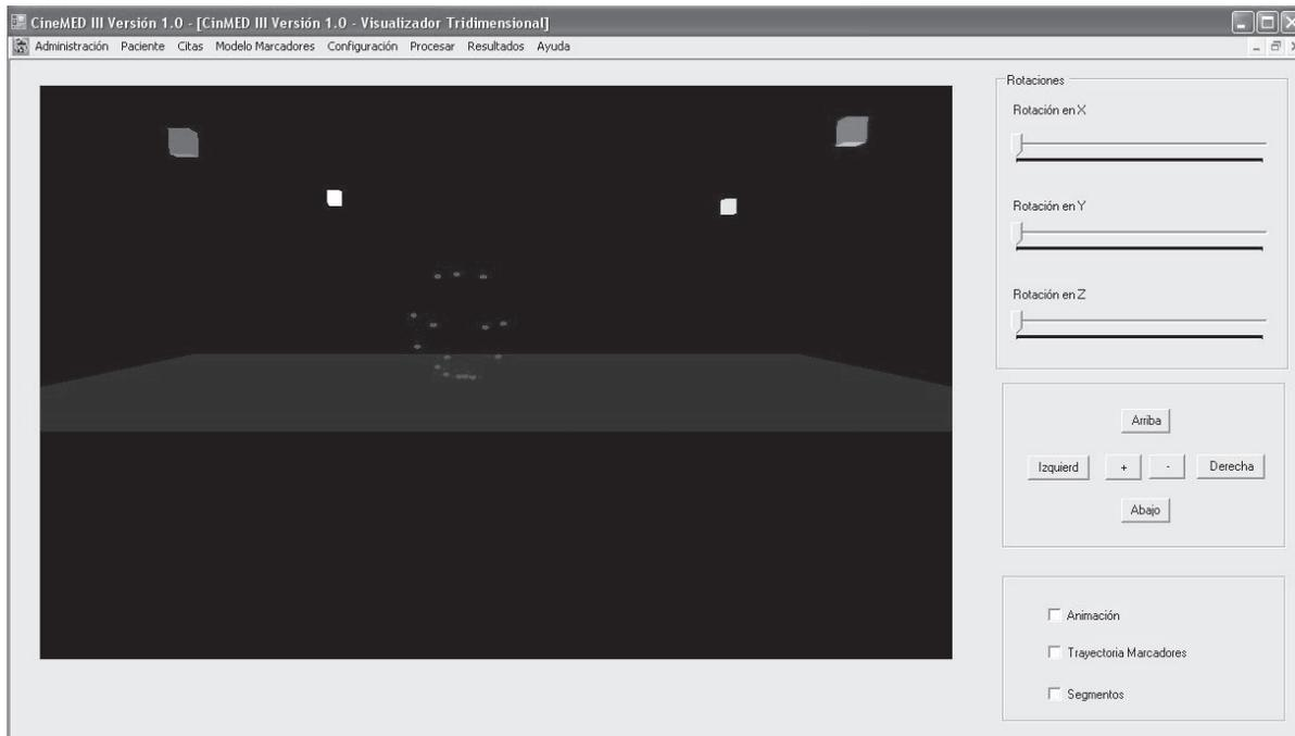
**Figura 12.** Reconstrucción tridimensional de la trayectoria de los 15 marcadores durante un gesto de marcha por medio de CineMED III. Las herramientas que se aprecian en la parte izquierda corresponden a opciones que permiten al usuario apreciar la marcha desde los diferentes planos del movimiento así como también observar las trayectorias de cada uno de los marcadores durante el gesto realizado.
