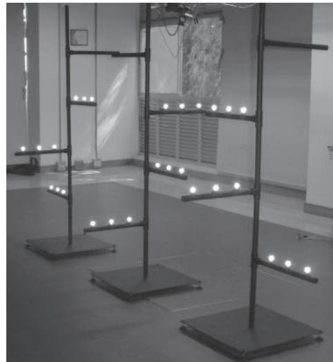
**Fig. 8.** Dispositivos de calibración utilizados para hallar los parámetros DLT de las cámaras. Después de realizar el proceso de calibración de las cámaras se puede llevar a cabo la reconstrucción tridimensional de los puntos, ya que las únicas incógnitas en este caso son las tres coordenadas del punto en el espacio.
