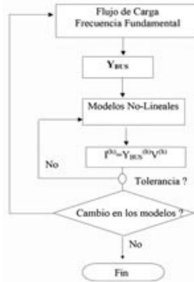
Figura 3: Diagrama de flujo del algoritmo de penetración armónica iterativa
