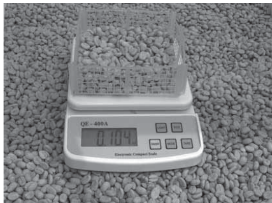
Figura 14. Método para medir la humedad del café en secado solar (Gravimet)
