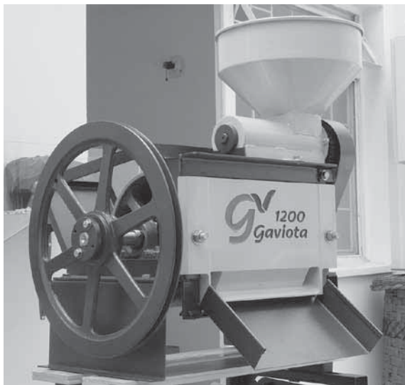
Figura 10. Máquina para despulpar café diseñada por Cenicafé y la empresa Ingsec Ltda.
