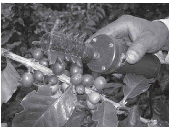
Figura 4. Sistema portátil y motorizado Alfa para la cosecha semi-mecanizada de café
