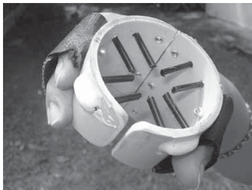
Figura 3. Dispositivo Raselca para asistir la cosecha manual de café
