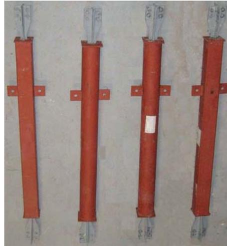
Figura 3. Presentación final de las probetas de BRB
