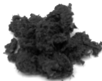
Figura 4. Fotografías de cascarrilla a) sin tratar y tratada por explosión con vapor 190°C, 10 min b) impregnada con agua, c) impregnada con ácido sulfúrico 0,5%.
