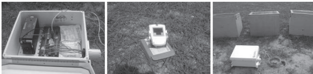
Figura 2. Conexión de las termocuplas al Sistema de toma de datos disposición del solarímetro durante las pruebas.
