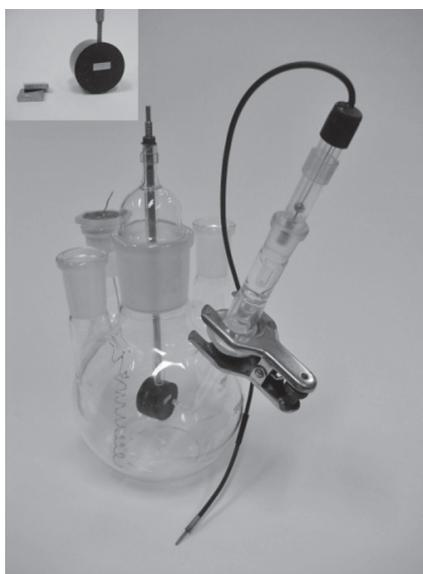
**Figura 1.** Configuración de las muestras y montaje de la celda electroquímica.
