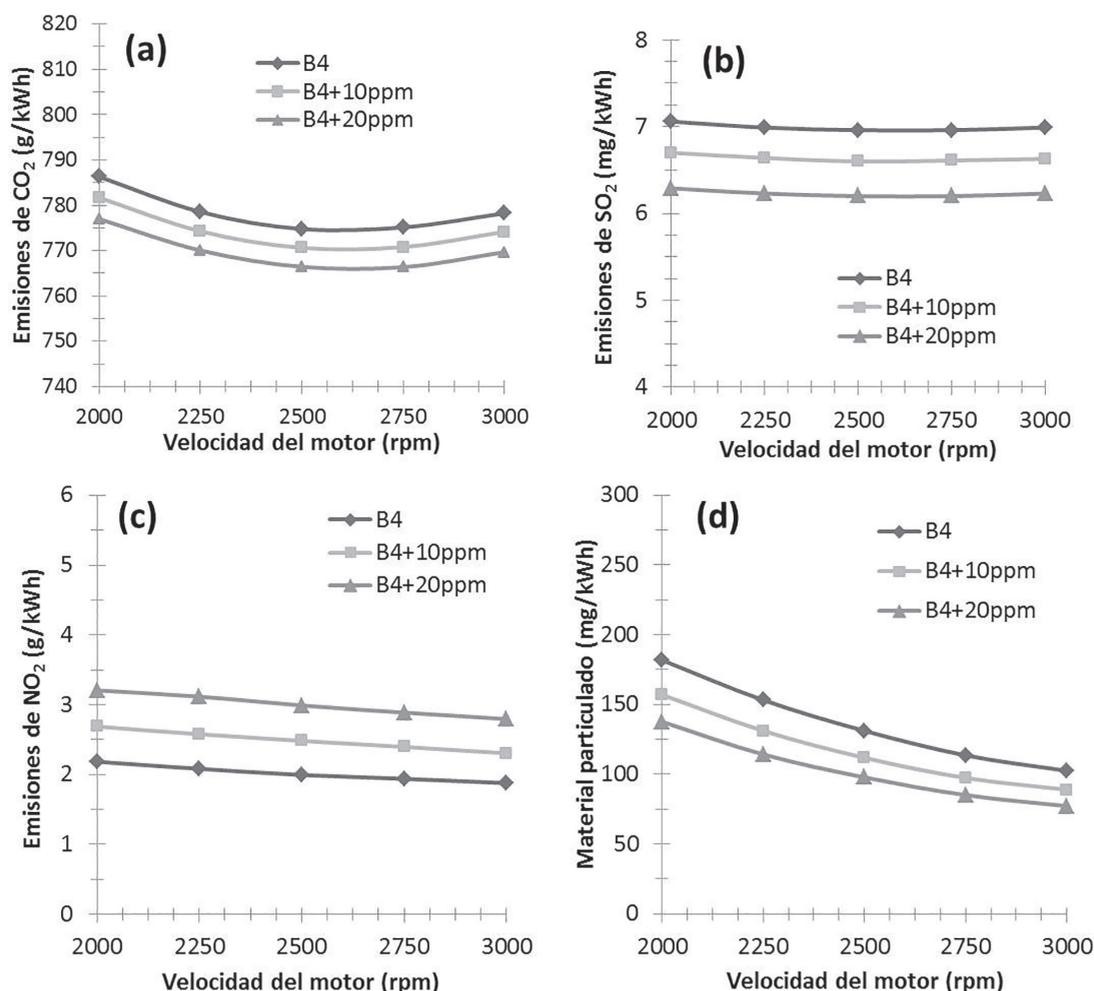
**Figura 1.** Predicción de emisiones para las mezclas combustibles como función de la concentración de nanoaditivos basados en ácido oleico y alúmina. (a) Emisión de CO<sub>2</sub>, (b) SO<sub>2</sub>, (c) NO<sub>2</sub> y (d) materia.
