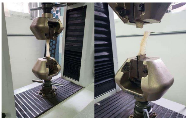
Figura 5. Desplazamiento de la mordaza móvil a una velocidad controlada de 50 mm/min hasta la falla.
