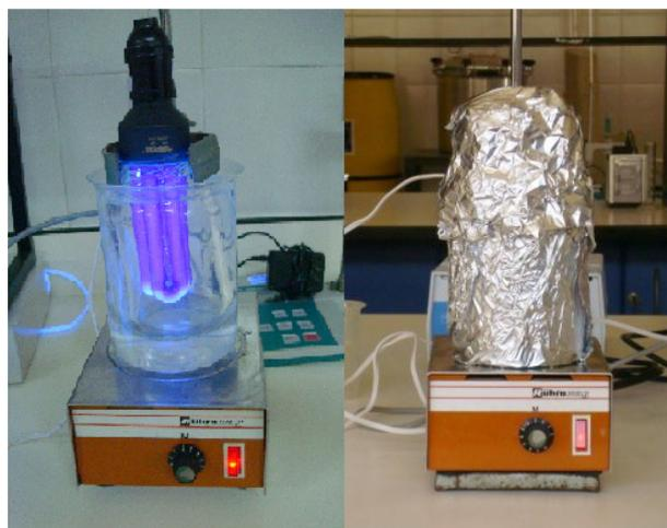
**Figura 3.** Montaje experimental del sistema fotocatalítico
