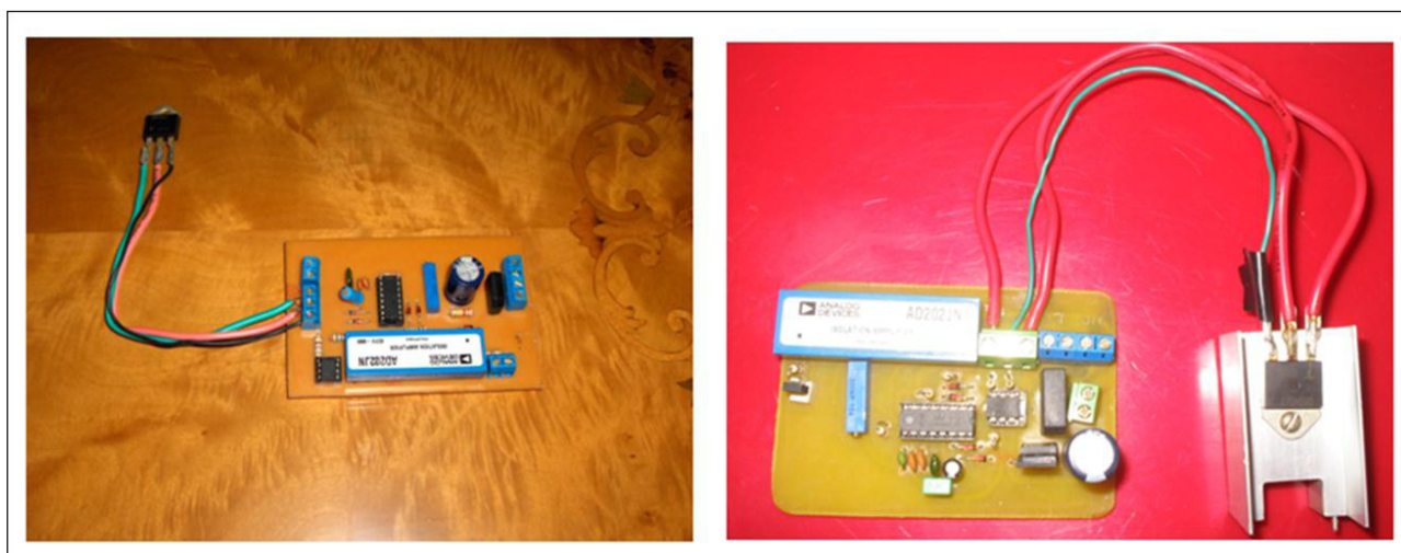
Figura 7. Circuitos de prueba, parte superior sin disipador (aletas), abajo con disipador
