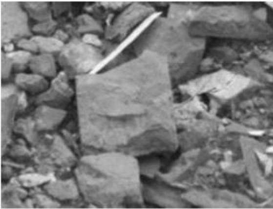
Figura 6. Tipo I / No. 3-88879. Agregados procedentes de escombros de albañilería y/o mampostería Fuente: Elaboración propia
