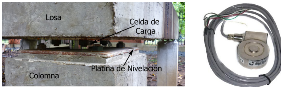
Figura 3. Celdas de carga Omega-Dyne LCD 401-10K.
