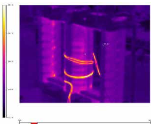
Figura 12. Termografía general. (Puntos calientes debajo de los fletajes)
