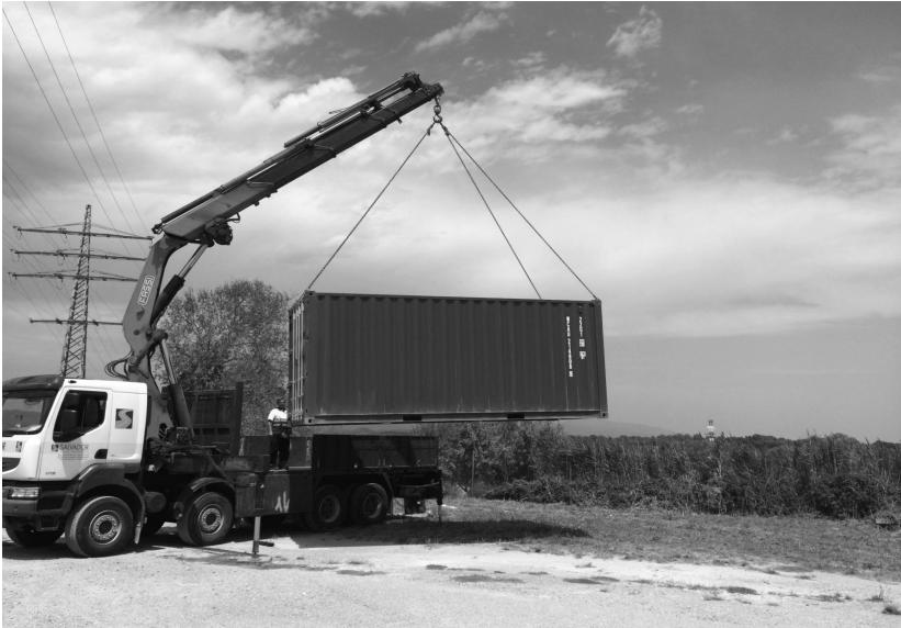
Figura 2. El piloto puede ser transportado por medio de un camión grúa o con pluma a las distintas ubicaciones donde sea requerido.
