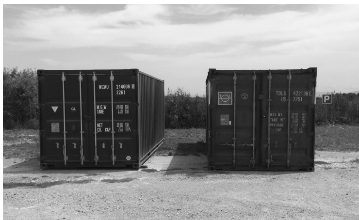
Figura 1. El uso de contenedores marítimos para la construcción del sistema de tratamiento permite su traslado a las parcelas donde se requiera la descontaminación del agua.
