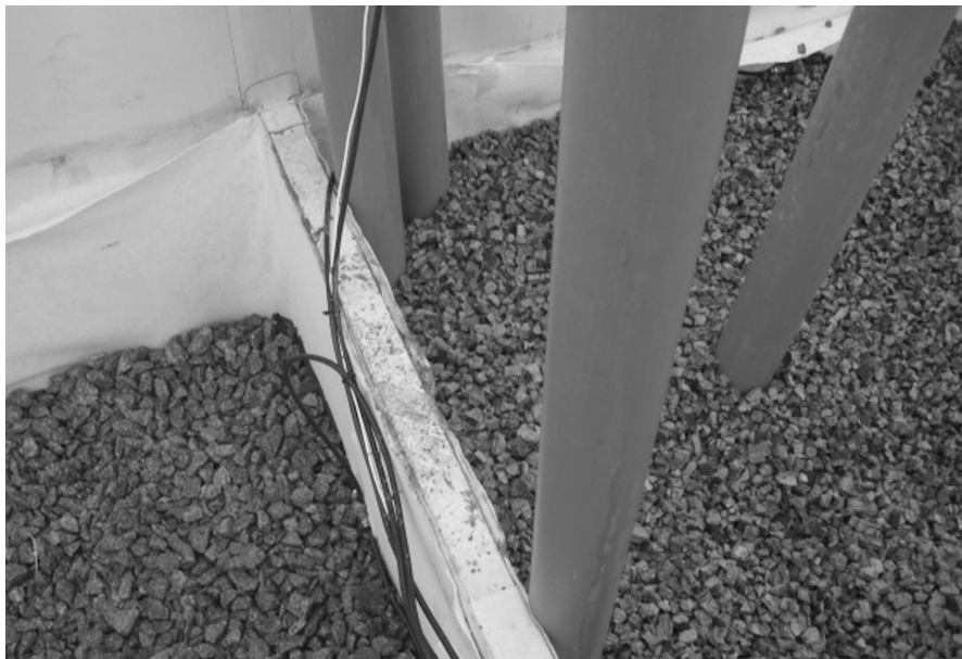
Figura 15. Materiales granulares (grava y corcho) utilizados en los humedales híbridos.
