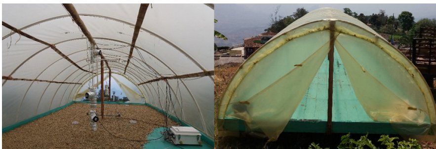
Figura 1. Estructura del secador solar tipo túnel
