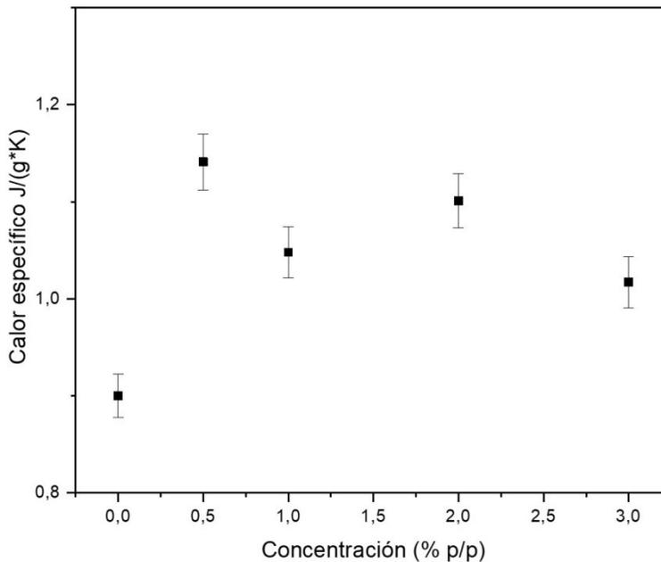
Figura 8.  $C_p$  de los nanocompuestos en matriz de poliuretano con diferentes concentraciones de NPs-TiO<sub>2</sub>.
