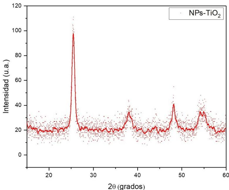
Figura 5. Difractograma de rayos X de las NPs-TiO<sub>2</sub>.
