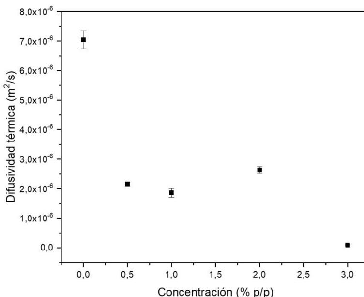
Figura 9. Difusividad térmica de los nanocompuestos en matriz de poliuretano con diferentes concentraciones de NPs-TiO<sub>2</sub>.
