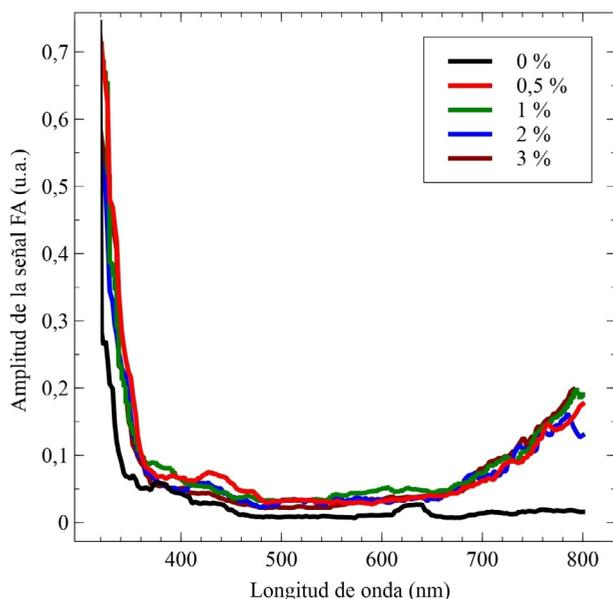
Figura 7. Espectros FA UV-Vis de los nanocompuestos en matriz de poliuretano con diferentes concentraciones de Nps-TiO<sub>2</sub>.
