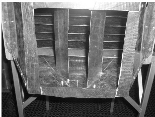
Figura 9. Álabes seleccionados para la distribución del flujo.
