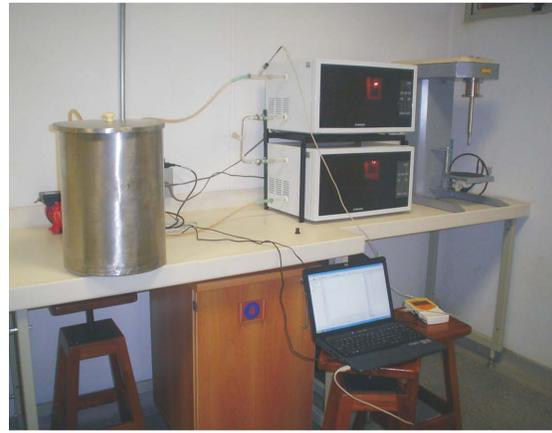
Fotografía 2. Sistema de procesamiento de microondas para conservación no térmica de alimentos fluidos
