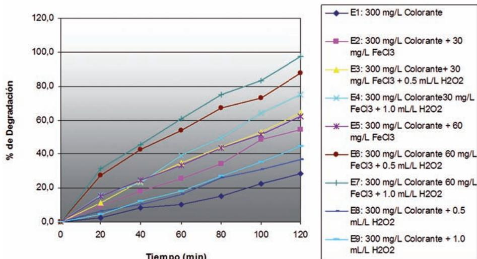
Figura 1. Porcentaje de degradación del colorante azul Novactive FHRNS con  $\text{FeCl}_3$  en los diferentes ensayos
