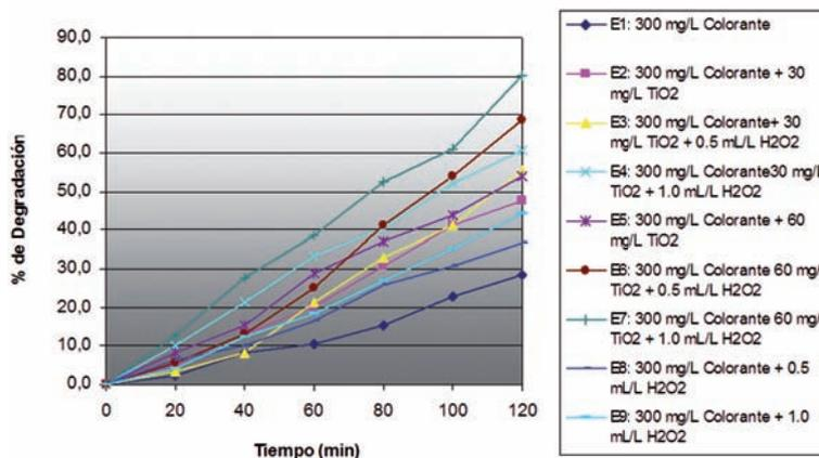
**Figura 3. Porcentaje de degradación del colorante azul Novactive FHBRNS con  $\text{TiO}_2$  en los diferentes ensayos**
