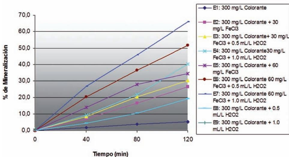
Figura 2. Porcentaje de mineralización del colorante azul Novactive FHRNS con  $\text{FeCl}_3$  en los diferentes ensayos
