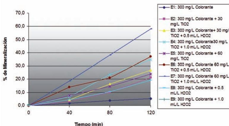
**Figura 4. Porcentaje de mineralización del colorante azul Novactive FHBRNS con  $\text{TiO}_2$  en los diferentes ensayos**
