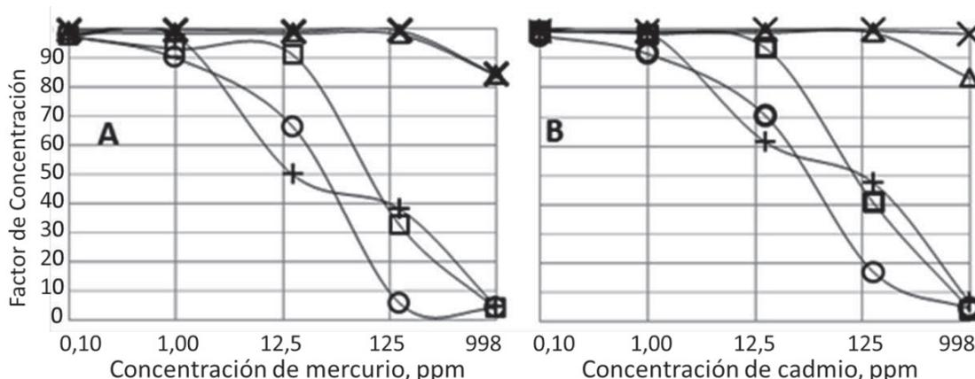
Figura 2. Capacidades de adsorción de mercurio (A) y cadmio (B) expresadas como FC. -□- CS; -○- CAC; -◇-CX; -×- RC; -+- CAp.
