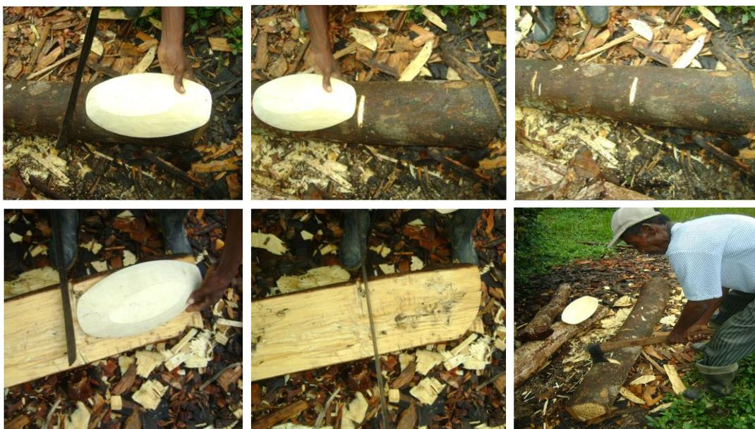
Figura 1. Cortes del tronco para obtener moldes de bateitas. Marcación adversa, tomando como referencia la longitud esencial de la forma.
