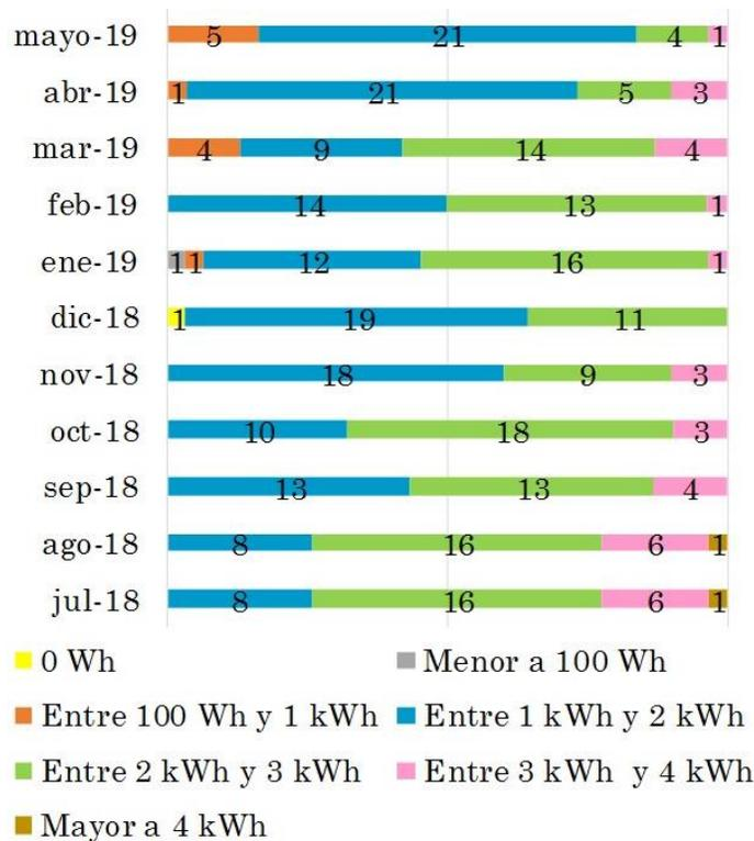
Fig. 11. Histograma mensual de generación arreglo fotovoltaico con microinversores. Fuente: elaboración propia.
