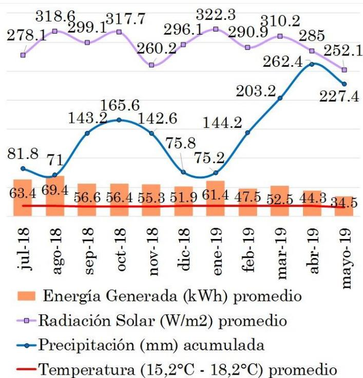
Fig. 7. Comparación índices climáticos con energía generada para el sistema fotovoltaico con inversor centralizado. Fuente: elaboración propia.
