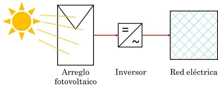
Fig. 1. Sistema fotovoltaico conectado a la red. Fuente: elaboración propia.
