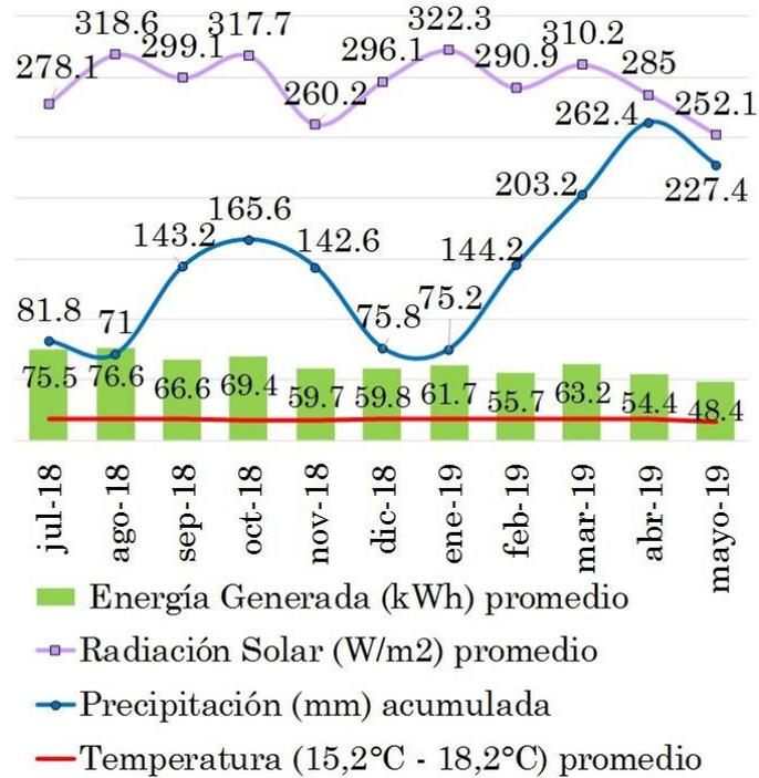
Fig. 6. Comparación índices climáticos con energía generada para el sistema fotovoltaico con microinversores. Fuente: elaboración propia.
