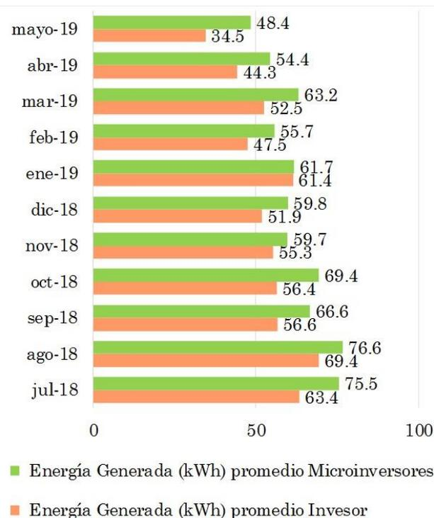
Fig. 8. Comparación datos de generación de ambos subsistemas. Fuente: elaboración propia.
