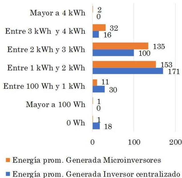
Fig. 9. Histograma comparativo ambos subsistemas. Fuente: elaboración propia.
