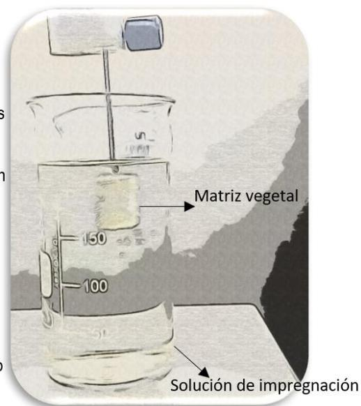
**Figura 1.** Funcionamiento base del mecanismo hidrodinámico (HDM). Fuente: elaboración propia.
