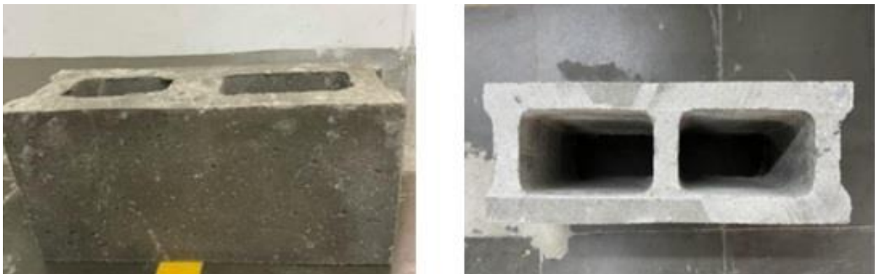
Figura 8. Bloques perforados de concretos fabricados con RV del 40 %. Fuente: elaboración propia.
