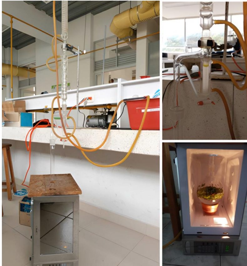
Figura 3. Sistema de extracción asistido por microondas. Fuente: elaboración propia.
