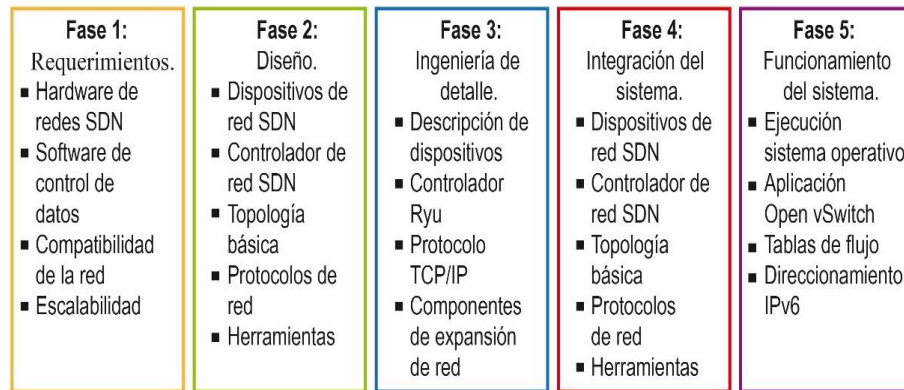
Figura 1. Estructura de la metodología Top Down. Fuente: elaboración propia adaptada de [7].
