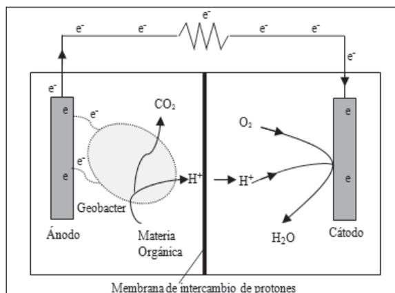
Figura 5. Esquema básico de una Celda de Combustible Microbiana.
