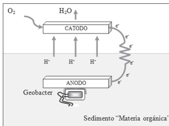
Figura 6. Funcionamiento de una celda microbiana de sedimento [34]
