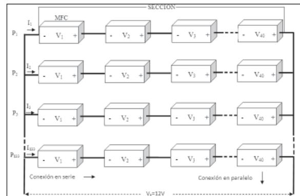
Figura. 8 Diagrama esquemático de un módulo compuesto por Celdas de Combustible Microbiana.
