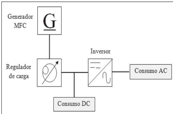
Figura 7. Esquema simple de un sistema eléctrico con módulos de celdas de combustible microbiana.
