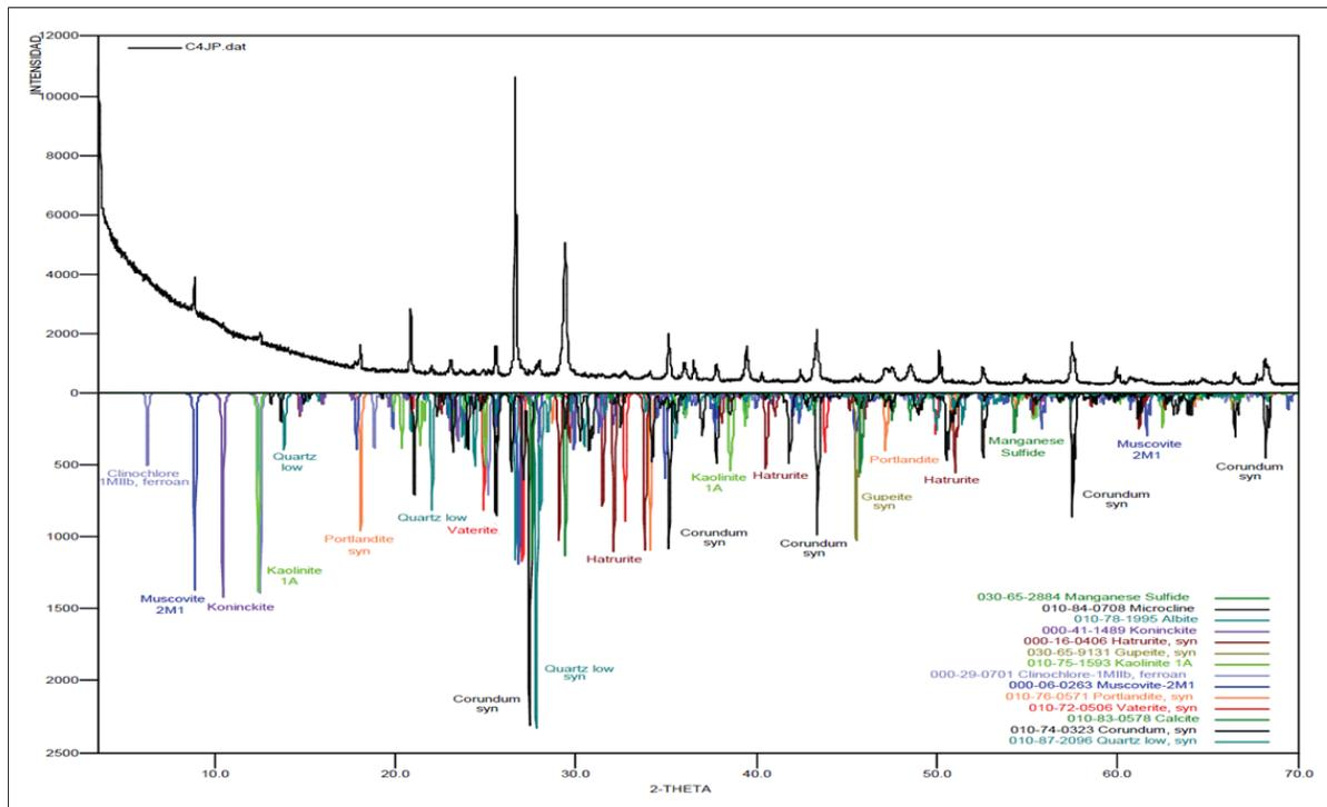
**Figura 5.** Espectro de rayos X del material compuesto
