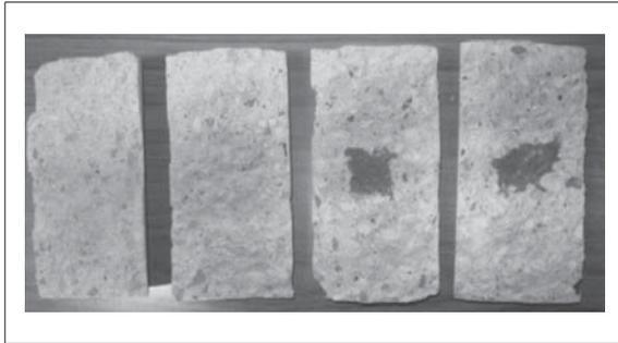
**Figura 10.** Profundidades de carbonatación para 0, 10, 15 y 20% de sustitución
