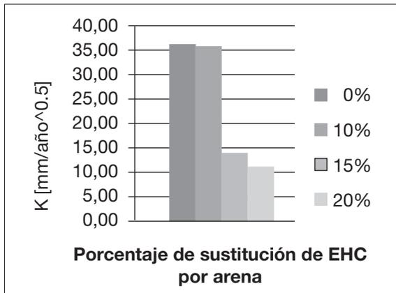
**Figura 12.** Coeficiente de carbonatación [K] a concentración ambiente [0,039%]
