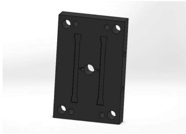
**Figura 2.** Placas del molde realizadas en SolidWorks.
