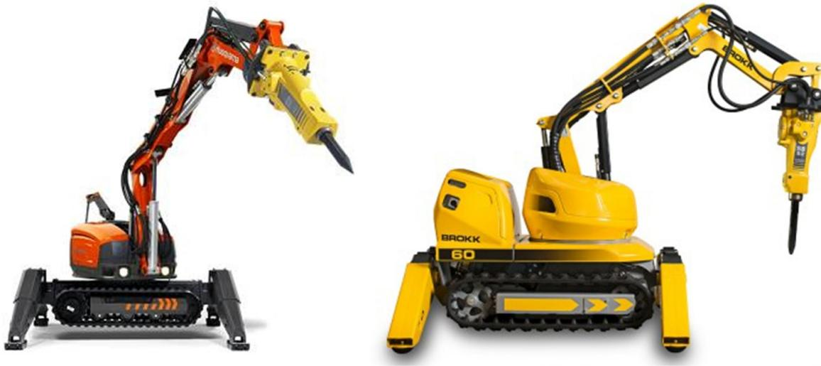
**Figura 6.** Robot de demolición de Husqvarna (izq.). Robot de demolición de Brokk (der.)
