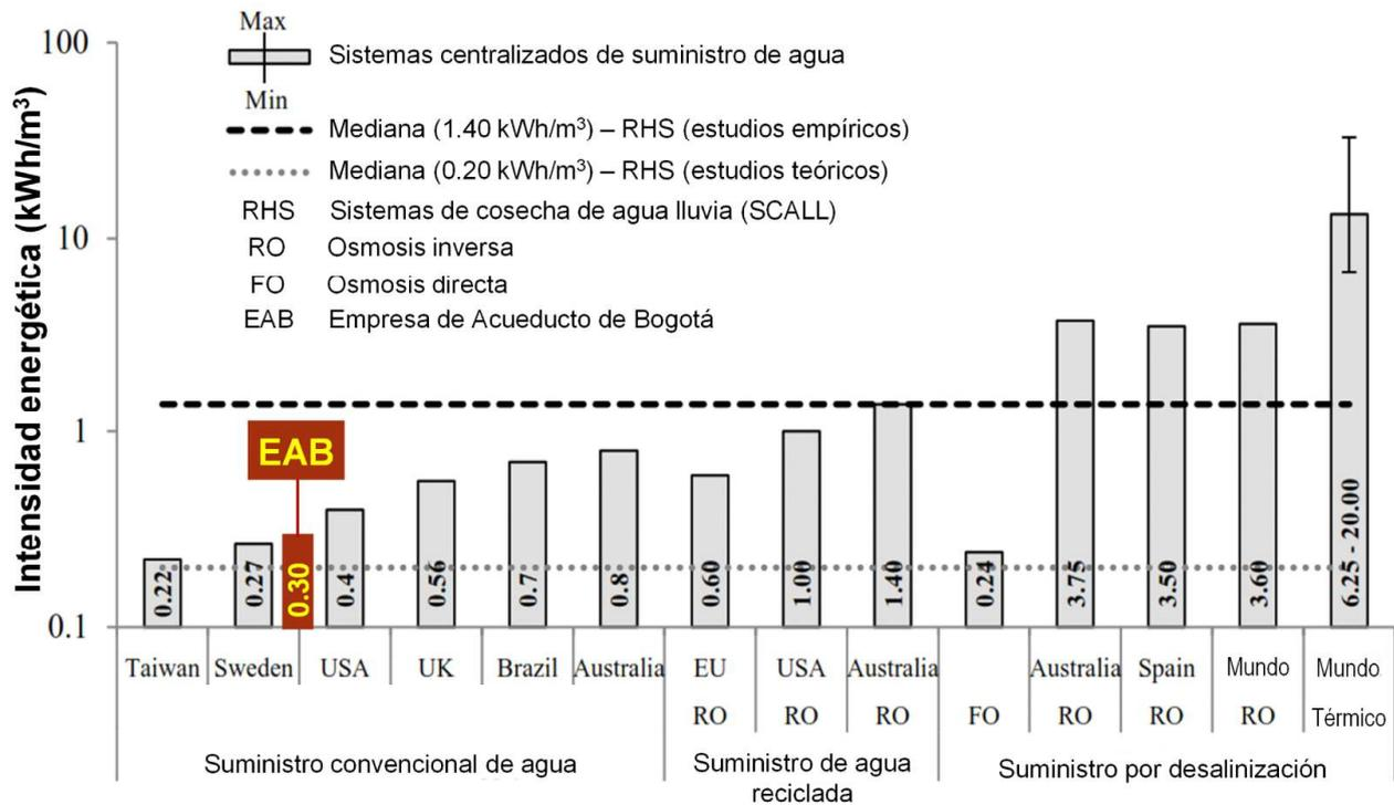
**Figura 1.** Comparación de la intensidad energética entre los sistemas de suministro centralizados y los SCALL (RHS)
