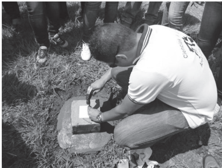
Figura 2. Trabajo en el proceso de monumentación de los puntos GPS en campo
