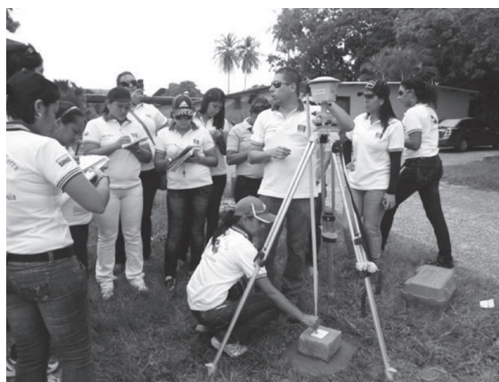
Figura 3. Actividades de medición de los puntos GPS en la estación rover
