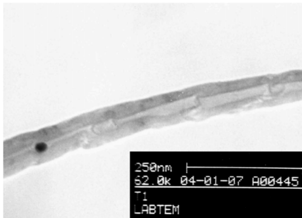
Figura 4. Fotografía con microscopio electrónico de transmisión de nanotubo de carbono tipo bamboo obtenido por síntesis con microondas.
