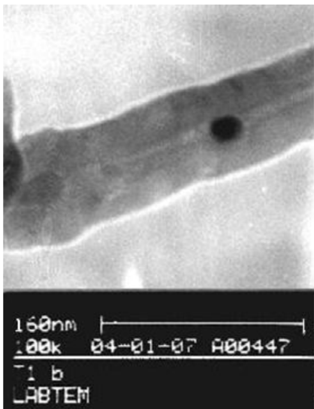
Figura 3. Fotografía con microscopio electrónico de transmisión de nanotubo de carbono (100000 aumentos) sintetizado con microondas. Se observa la presencia de nanopartícula de plata de 21 nm de diámetro en su interior identificada con EDX, lo que posibilita una vez funcionalizado el nanotubo para su solubilidad en agua y reconocimiento molecular contar con un nanovector para diagnóstico y tratamiento.
